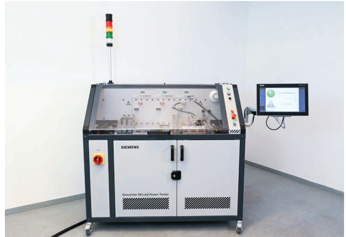
Abbildung 2: Der Simcenter Micred Power Tester ist für die Fertigung von Halbleitern entwickelt.
